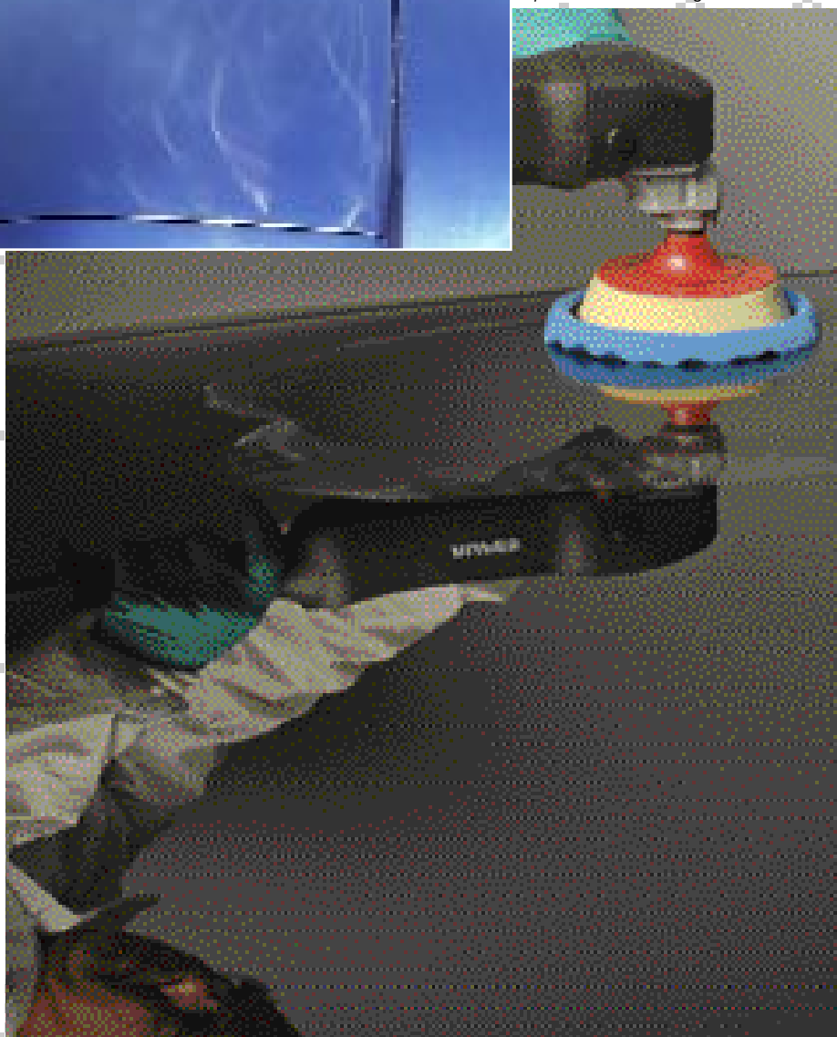
Hieronder; met 3M™ Perfect-it™ III Ultrafina™ SE worden machinedraaiingen en hologrammen verwijderd en wordt een perfecte finish verkregen
